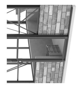
Aan de voorzijde van de kas komt buiten de muur een deurgelijder van 50mm breed op de bodem. Daarom moet er aan de voorzijde ondersteuning zijn (bijvoorbeeld een betonnenrand) die op dezelfde hoogte ligt als de deur.
